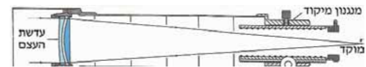
תאור סכמטי של מעבר קרני האור במערכת של שובר אור אכרומטי
