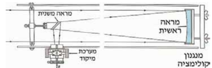
תאור סכמטי של מעבר קרני האור במערכת מחזירי אור
